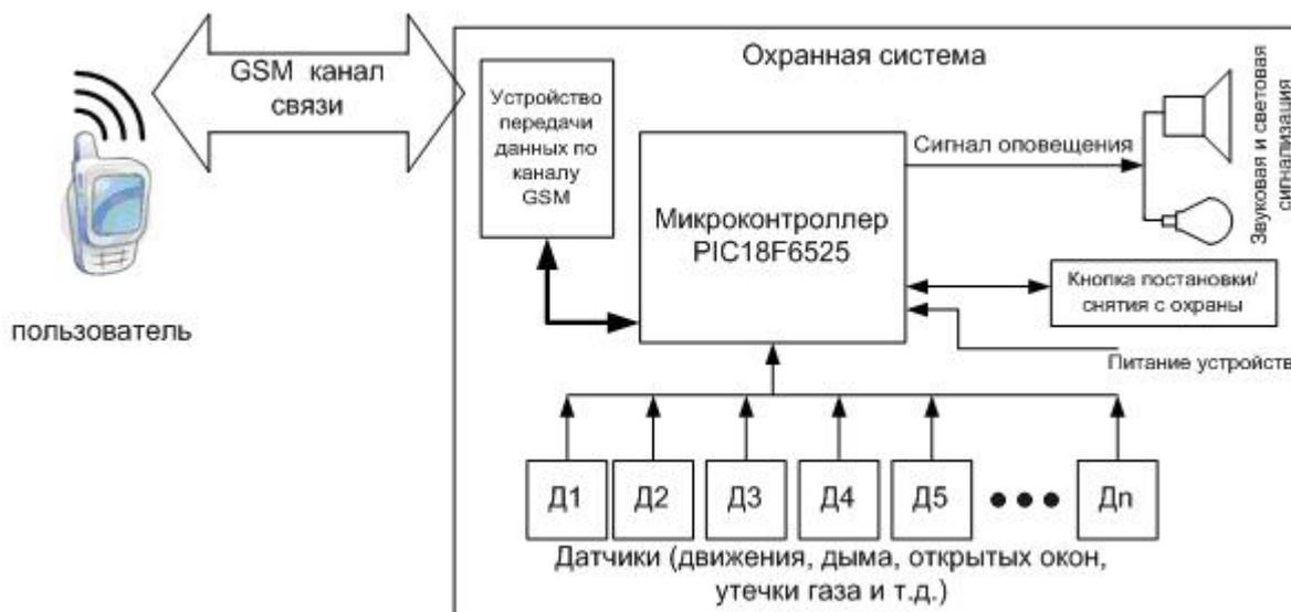
Рис. 1. Структурная схема системы охранной сигнализации
